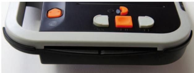
En-dessous de ces touches, sur le bord inférieur de l'appareil, se trouve la fente d'insertion du CD dans le lecteur, munie à sa partie inférieure d'une languette-guide arrondie dont le centre porte un creux facilement identifiable au toucher.
