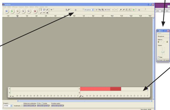
Tout en parlant dans le micro (et en ayant activé le vu-mètre d'Audacity) réglez le niveau pour que le sommet du thermomètre oscille entre -12 et -3. Occasionnellement, il peut atteindre le zéro à condition que ce soit pour un instant très bref (une exclamation par exemple)
