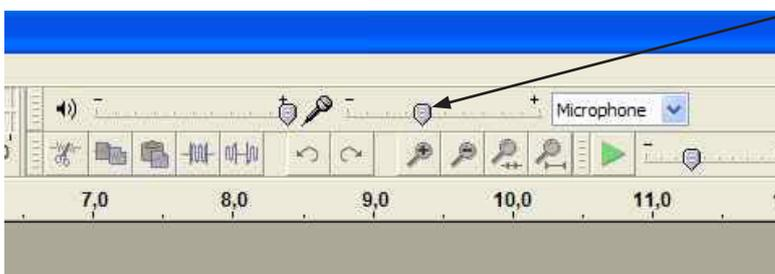
Placez le curseur au maximum : le thermomètre doit arriver au zéro du vu-mètre, complètement à droite.
